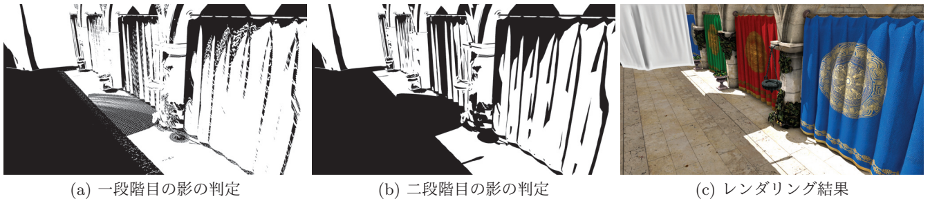
図1 本論文のハードシャドウの描画パイプラインで出力した visibility mask buffer (a, b) と最終レンダリング結果 (c) Fig. 1 Visibility mask buffer (a, b) and final result (c) rendered using our hard shadow rendering pipeline
